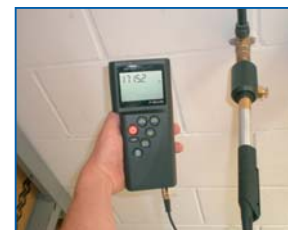
Restfeuchtefühler für Druckluftanlagen (bis 25 bar druckdicht) Pressure-tight moisture probe for measuring in compressed air
