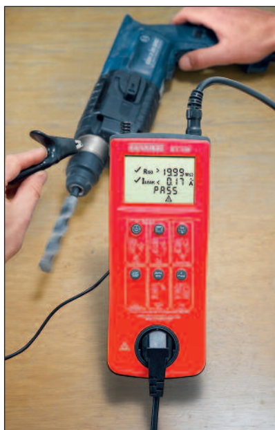
Bild 1: Isolations-/Berührungsstrommessung an einem ortsveränderlichen Arbeitsmittel – Prüfgerät ohne Datenspeicher, im Batteriebetrieb R_{PE} -, R_{Iso} - und Ersatz-Ableitstrommessungen, im Netzbetrieb Differenzstrommessung (direkte Messung) möglich
